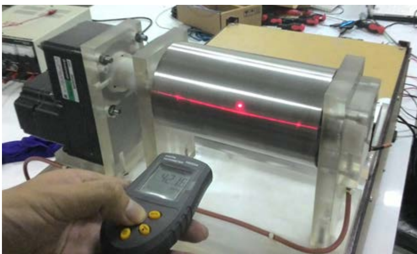
รูปที่ 4.2 การทดสอบความเร็วแป้นรองรับเส้นใยที่ความเร็วรอบ 40 ถึง 640 รอบต่อนาที
