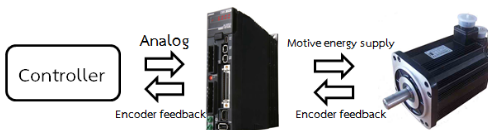
รูปที่ 2.17 ตัวอย่างของ การควบคุมเซอร์โวมอเตอร์โดยใช้สัญญาณอนาล็อก
