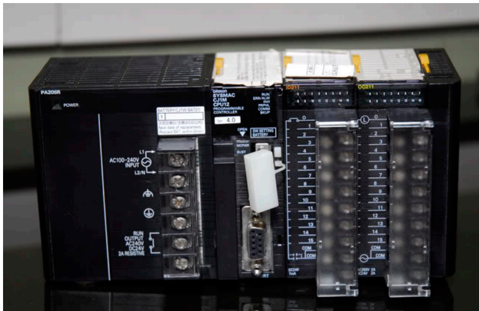
รูปที่ 2.10 แสดงตัวอย่างของพีแอลซีชนิดโมดูล (Modular Type PLCs)
