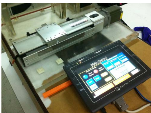
รูปที่ 4.6 การทดสอบตำแหน่งระบบควบคุมหัวฉีดเส้นใยที่ระยะทางรอบ 1 ถึง 10 เซนติเมตร
