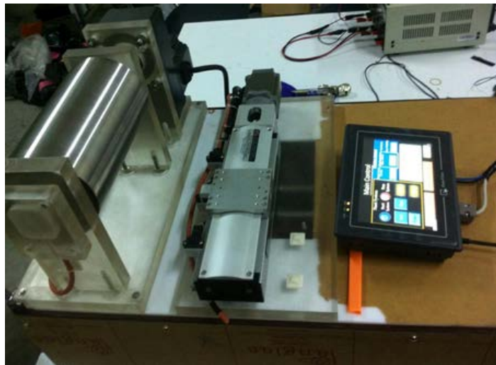
รูปที่ 4.1 ชุดทดสอบระบบควบคุมแป้นรองรับเส้นใยจากเครื่องปั่นเส้นใย
