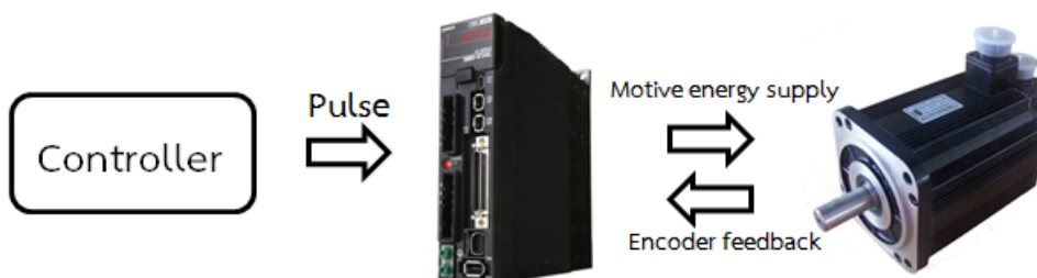
รูปที่ 2.16 ตัวอย่างของ การควบคุมเซอร์โวมอเตอร์โดยใช้สัญญาณพัลส์
